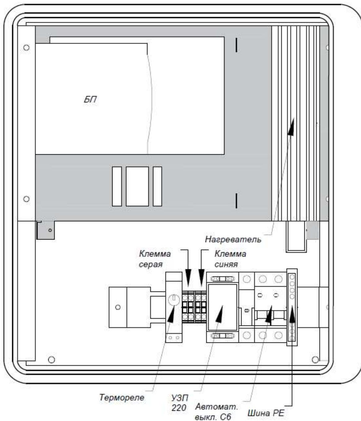
Рисунок 2 – Внешний вид кассеты с ИБП и нагревателем
