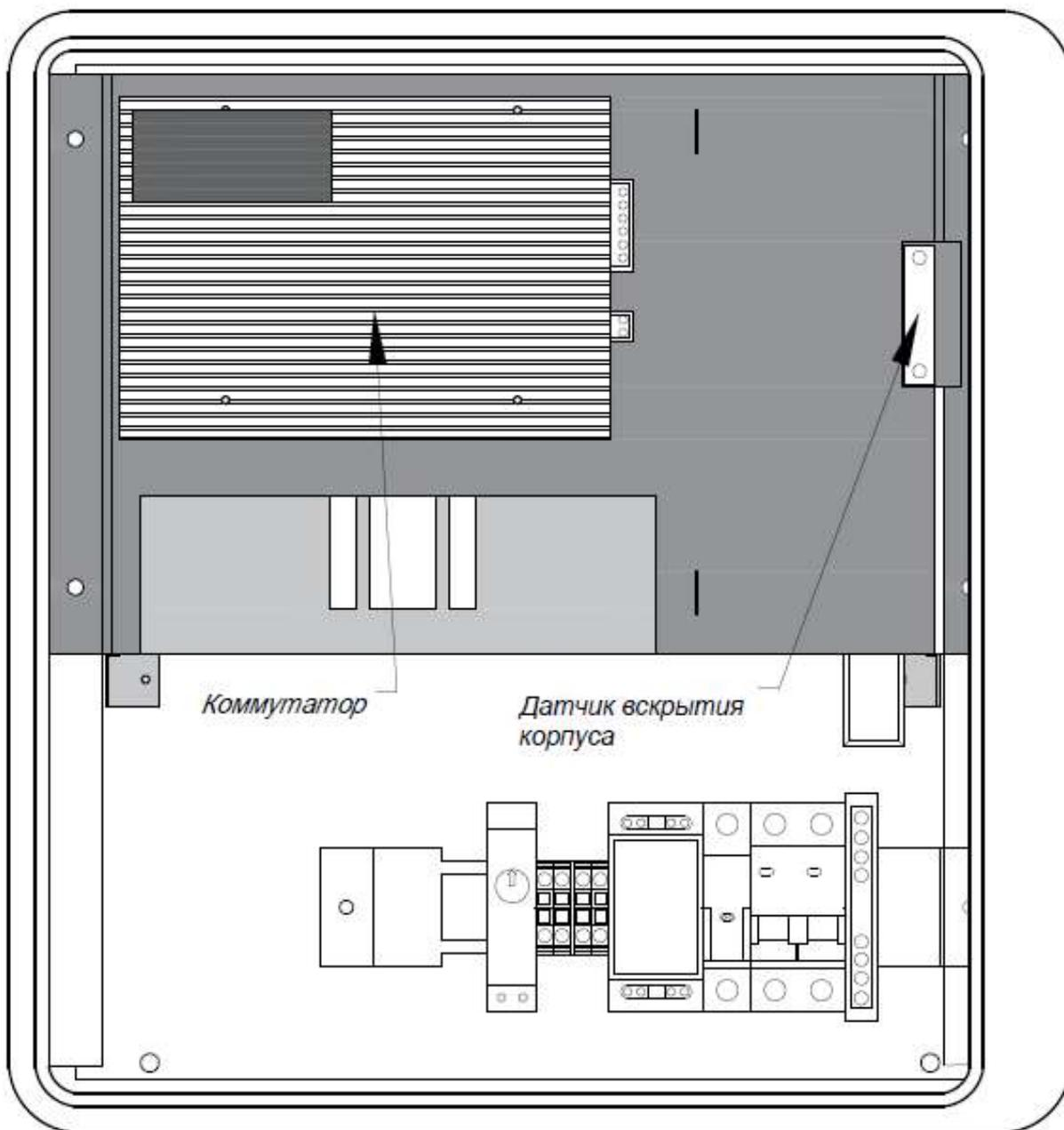
Рисунок 1 – Общий вид расположения оборудования
